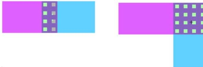
Zur Reduzierung der Kontaktwiderstände zwischen den einzelnen Ebenen verwendet man möglichst viele parallel geschaltete Verbindungen, die üblicherweise als Quadrat ausgelegt werden.
